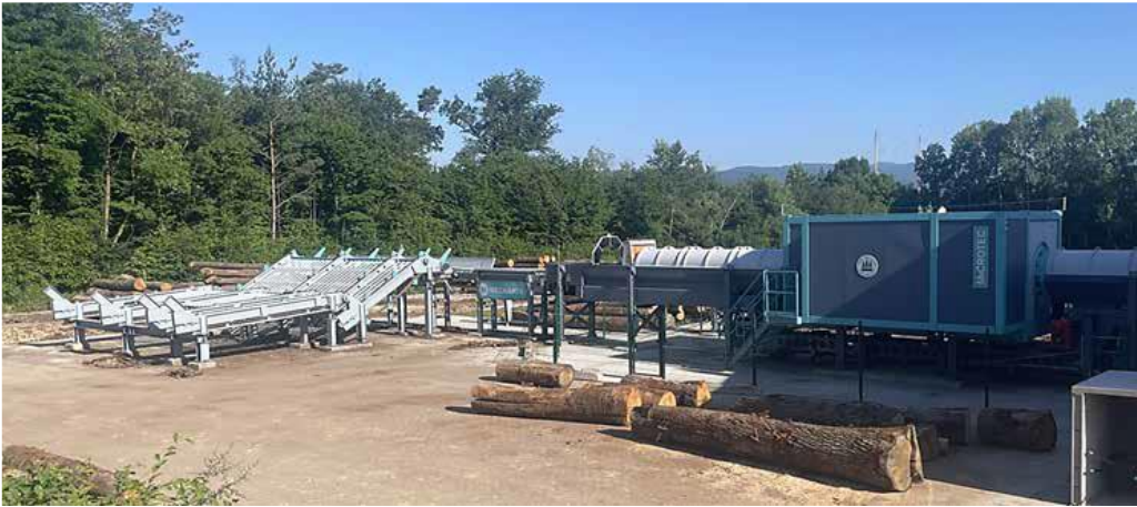
Figure 7: 3D CT line and conveyor system (Source: Výstupy NLC pre lesnícku prax VI., 2024)
